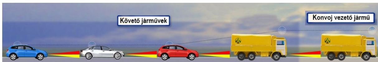
Lineáris, heterogén járműplatformokból álló ad-hoc szerveződésű konvoj automatikus irányítása
