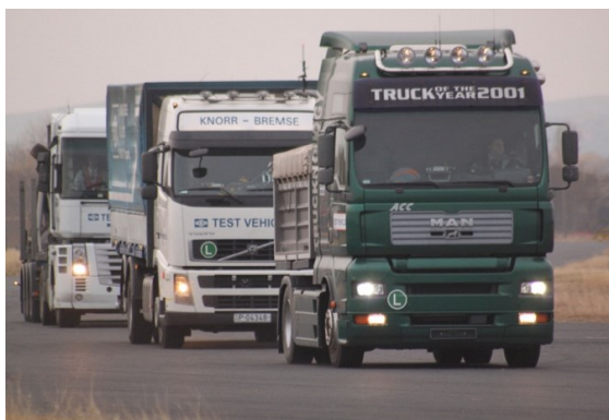
A haszongépjármű platformra kifejlesztett platooning technológia zártpályás demonstrációja a Knorr-Bremse kísérleti járműparkja segítségével
